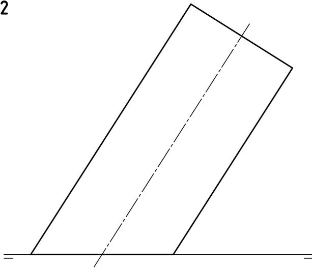
Representar la vista en planta del cilindro, que es de revolución y de eje frontal.
